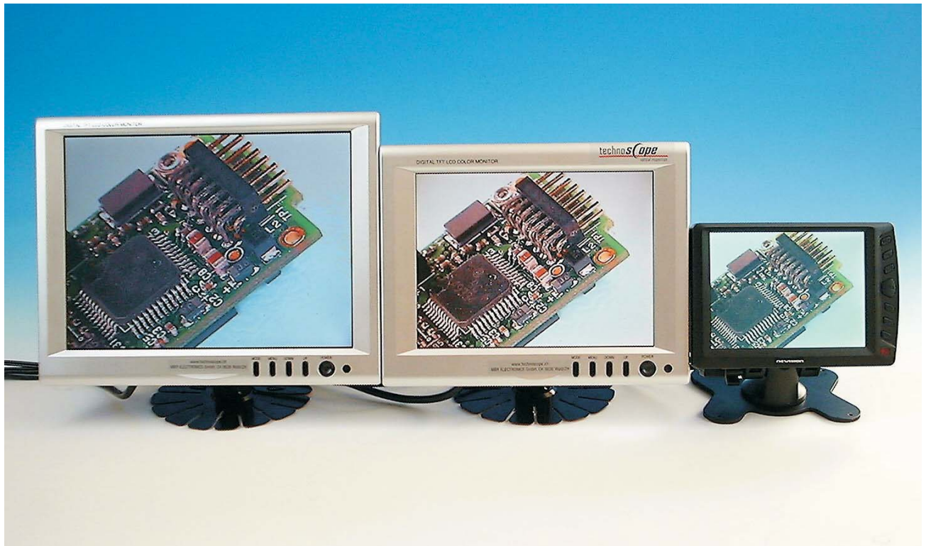
TFT-Monitore für Videomikroskop 10,4" (264 mm Diagonale), 8,4" (213 mm Diagonale), 5,6" (142 mm Diagonale)
